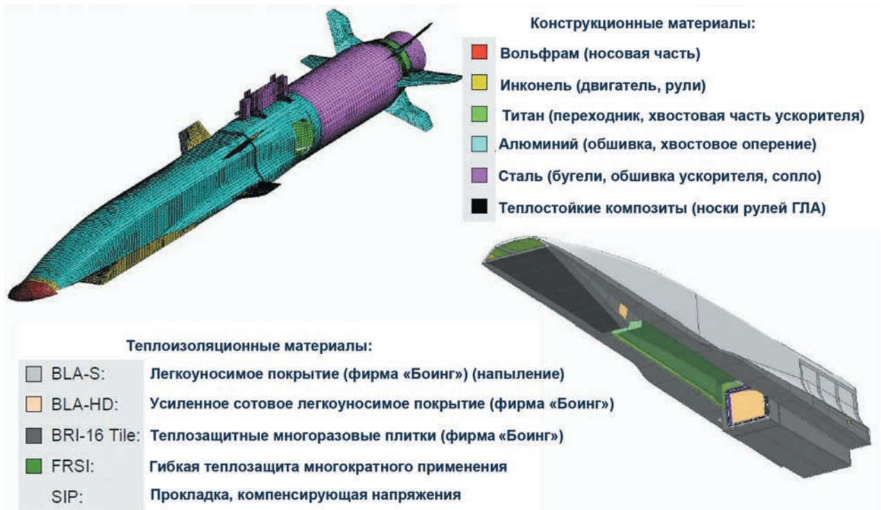
Конструкционные материалы аппарата X-51A
