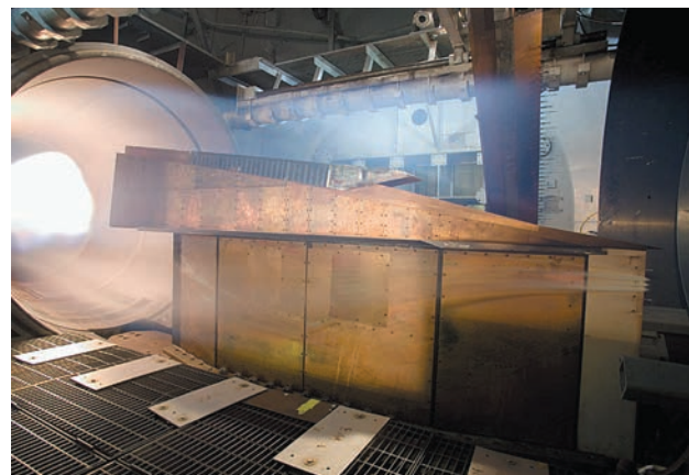
Испытания второго демонстрационного ГПВРД SJX61-1 для ГЛА X-51A в АДТ НИЦ им. Лэнгли при M = 5.5
