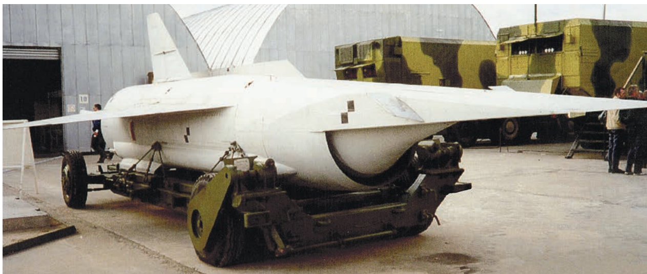
Гиперзвуковой экспериментальный летательный аппарат интегральной компоновки с экраным воздухозаборником на выставке «МАКС-1995»
