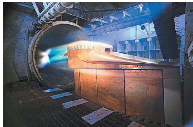
Испытания модификации двигателя GDE-2 с системой охлаждения в АДТ (март 2006 г.)
