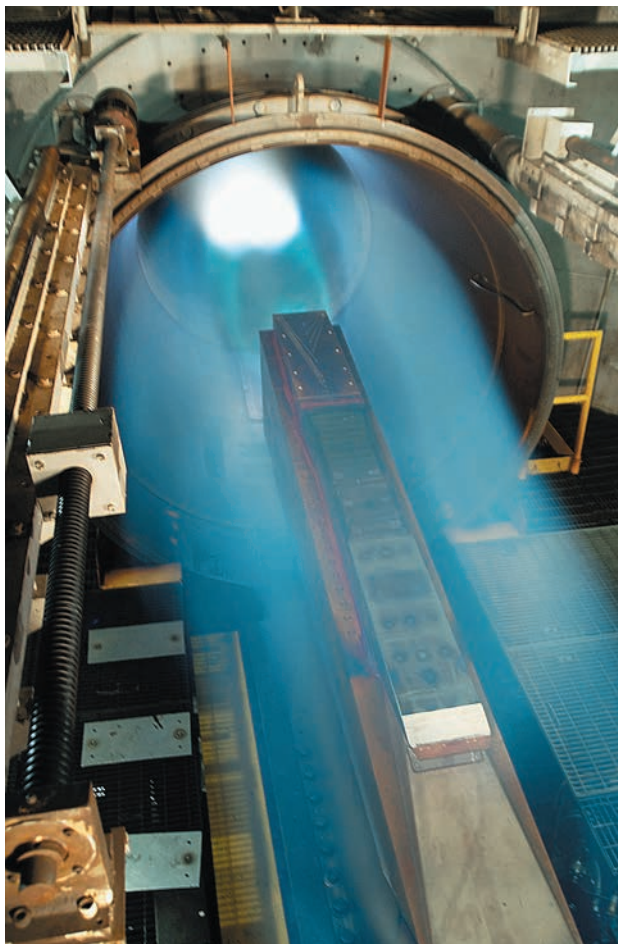
Испытания в АДТ двигателя SJX61-2 (октябрь 2008 г.)
